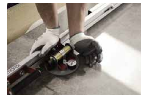
Per facilitare la movimentazione di lastre con superfici strutturate si consiglia l'utilizzo di ventose idonee.
