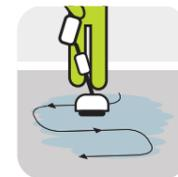
Distribuire la soluzione uniformemente sui residui posizionati sul pavimento, utilizzando una macchina o una penellessa.
