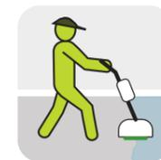
Limpiar el pavimento con un cepillo o una máquina, utilizando el disco verde.
