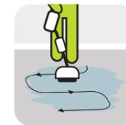
Distribuir la solución de manera uniforme sobre los residuos del pavimento, utilizando una máquina o un pincel plano.
