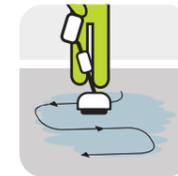
Distribuir la solución de manera uniforme sobre el pavimento, frotando solo unos metros cada vez. Podrá utilizarse una máquina o un cepillo.
