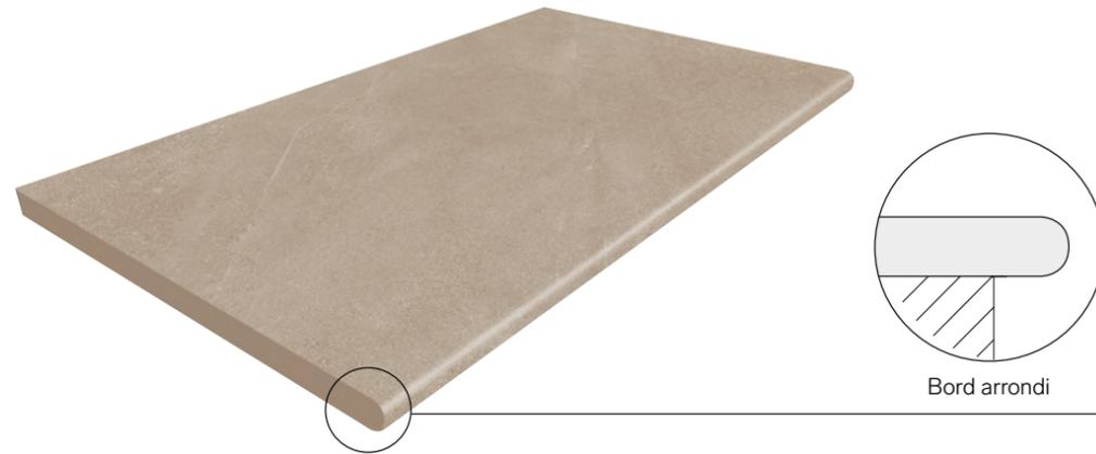
UNICO 2.0 est une pièce spéciale en grès cérame 20 mm rectifié uniquement sur les 2 côtés courts. Il sera donc nécessaire de la poser avec un **joint de 4 mm**.
