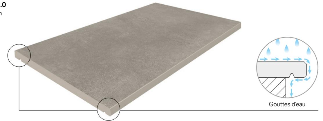
Le **COUVERTINE 2.0** est une pièce spéciale en grès cérame 20 mm rectifié uniquement sur les 2 côtés courts. Il sera donc nécessaire de la poser avec un **joint de 4 mm**.
