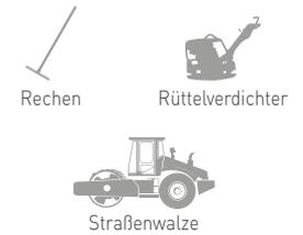
**i** Zum Verdichten kann man einen Rüttelverdichter oder eine Straßenwalze verwenden. Je nach dem Gewicht des Geräts ist die Materialdicke, die tatsächlich verdichtet wird, unterschiedlich. Neben dem Gewicht hängt die Anzahl der Durchgänge, um die optimale Dichte zu erzielen, außerdem von der Rüttelfrequenz, mit der man den Vorgang durchführt, und dem Wassergehalt ab. Je nach diesen Parametern muss der Vorgang mindestens zwei bis drei Mal wiederholt werden (fallweise entscheiden).
