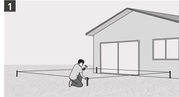
Sobald das Aushubprojekt vollendet ist, kann man den Grubenbereich mit Holz- oder Stahlpfosten, die mit einem Seil verbunden werden, abgrenzen. Als Toleranzbereich sollte ein seitlicher Bereich berücksichtigt werden, der über den markierten Umfang hinausgeht und in der Aushubphase entfernt werden könnte.
