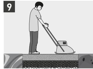
Das zum Verlegen von EVO\_2/E™ empfohlene Sandmaterial besteht aus trockenem Splitt mit 0-2 mm Körnung. Vergewissern Sie sich, dass die Sandschicht 2 bis 5 cm dick ist und verdichten Sie sie mit einem Rüttelverdichter.
