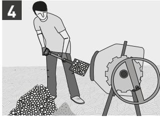
Der 10-20 cm dicke Estrich muss je nach Einsatzklasse einen idealen Untergrund für den Fußboden gewährleisten. Zusätzlich zu seiner strukturellen Aufgabe muss der Estrich das seitliche Abfließen des Wassers ermöglichen. Daher wird eine Neigung der Estrichoberfläche von 2-5% empfohlen.
