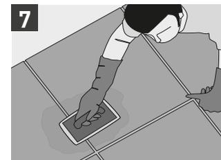
Man muss unbedingt eine Endreinigung mit Puffersäure durchführen, um eventuelle unsichtbare Mörtelrückstände zu entfernen.
