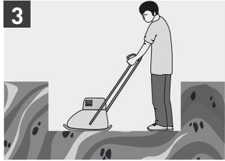
Nach Fertigstellung der Aushubarbeiten kann man den ausgehobenen Bereich mit einem Rechen oder einer Schaufel ebnen. Dabei sicherstellen, dass die Neigung mindestens 2% beträgt (um den Wasserabfluss zu erleichtern). Vor der Verlegung der oberen Schichten den Boden mit einem Rüttelverdichter verdichten.
