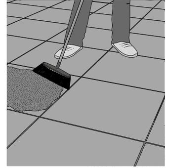
**!** VON FUGEN ÜBER 4 MM WIRD ABGERATEN. IM UNTERSCHIED ZUM POLYMERSAND HÄRTET DER ZEMENTSAND AUCH BEI REGEN ODER EINEM HOHEN FEUCHTIGKEITSGRAD, NICHT ABER BEI TEMPERATUREN UNTER 0°C.
