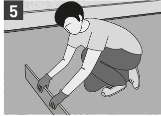
Es wird empfohlen, zum Betonieren eine Einwegschalung zu verlegen. Danach verlegt man eine Baustahlmatte mit Stangen mit einem Durchmesser von mindestens 8 mm auf der ganzen Oberfläche des Estrichs. Danach wird betoniert, wobei man sicherstellen sollte, dass der Beton möglichst gleichmäßig ist und die Oberfläche mit einer Wasserwaage mit einem Gefälle von 2-5% perfektionieren. Bevor man mit den weiteren Schritten fortfährt, muss man warten, bis der Beton härtet.
