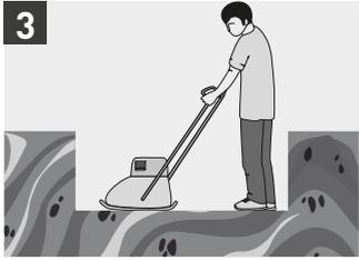
Nach Fertigstellung der Aushubarbeiten kann man den ausgehobenen Bereich mit einem Rechen oder einer Schaufel eben. Dabei sicherstellen, dass die Neigung mindestens 2% beträgt (um den Wasserabfluss zu erleichtern). Vor der Verlegung der oberen Schichten den Boden mit einem Rüttelverdichter verdichten.
