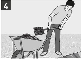
**4** Nach dem Verdichten des Untergrunds kann man die Fundamentschicht verlegen, auf der die rechtlichen Schichten aufliegen. Sie kann aus feinem Kies oder Sand und je nach Art der voraussichtlichen Belastung zwischen 20 und 30 cm dick sein.
