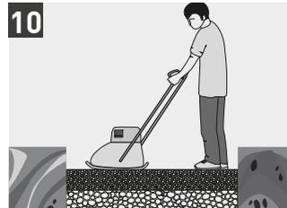
Mit den für die Fundamentschicht verwendeten Modalitäten eine je nach Art der vorgesehenen Belastung zwischen 10 cm und 20 cm dicke Schicht Kies mit 0-20 mm Körnung verlegen. Auch diese Schicht muss verdichtet und mit einer Neigung von ungefähr 2% planiert werden.
