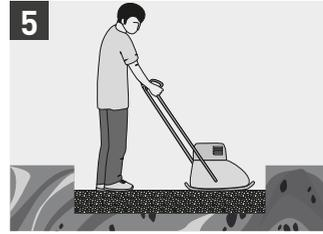
**5** Danach muss man die Kiesschicht mit einer Straßenwalze oder einem Rüttelverdichter verdichten, wobei man mit Hilfe eines Rechens eine gerade Oberfläche mit einer Mindestneigung von 2% schafft.
