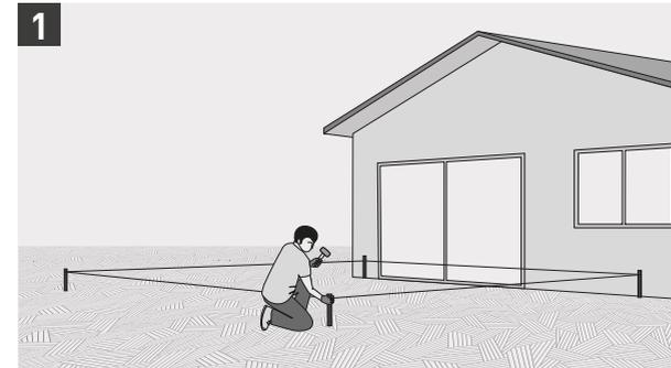
Sobald das Aushubprojekt vollendet ist, kann man den Grubenbereich mit Holz- oder Stahlpfosten, die mit einem Seil verbunden werden, abgrenzen. Als Toleranzbereich sollte ein seitlicher Erdstreifen berücksichtigt werden, der über den markierten Umfang hinausgeht und in der Aushubphase entfernt werden könnte.
