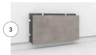
3 Fissare i pannelli tramite gli appositi ganci in acciaio inox con tasselli meccanici di lunghezza variabile a seconda del supporto.
