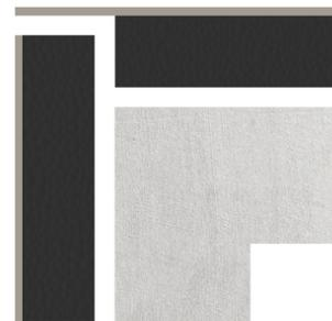
In prossimità degli angoli esterni di un edificio è necessario rimuovere la parti di EPS in eccesso e mascherare i bordi della lastra in gres porcellanato.
