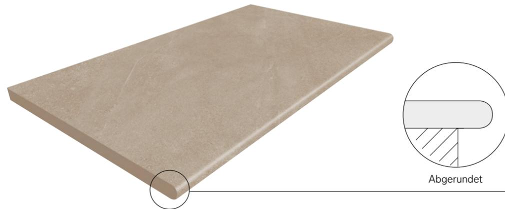
UNICO 2.0 ist ein Formteil aus 20 mm dickem Feinsteinzeug, der nur an den kurzen Seiten geschliffen ist. Zum Verlegen bedarf es daher einer **4 mm breiten Fuge**.
